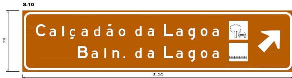
FIXAÇÃO: SUPORTE TIPO POSTE COM BRAÇO PROJETADO
