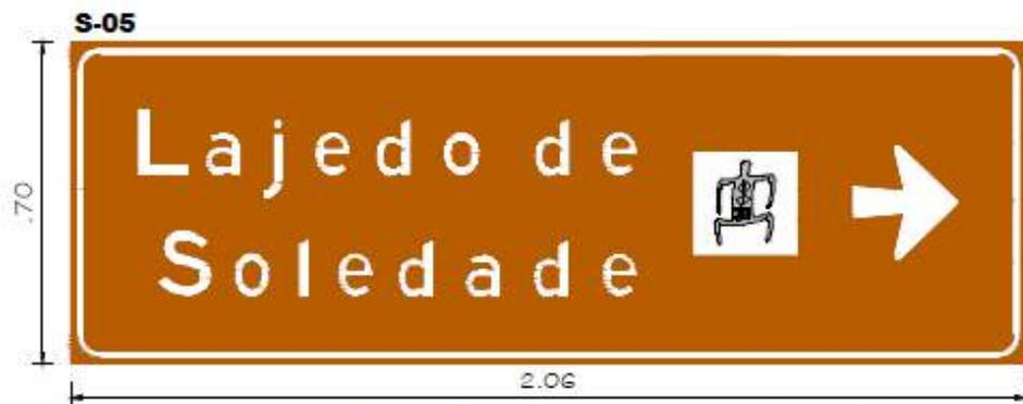
FIXAÇÃO: SUPORTE DUPLO EM TUBO DE AÇO GALVANIZADO
