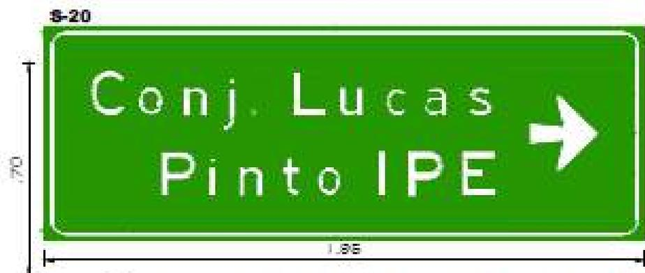
FIXAÇÃO: SUPORTE TIPO PÓSTO COM BRAÇO PROJETADO
