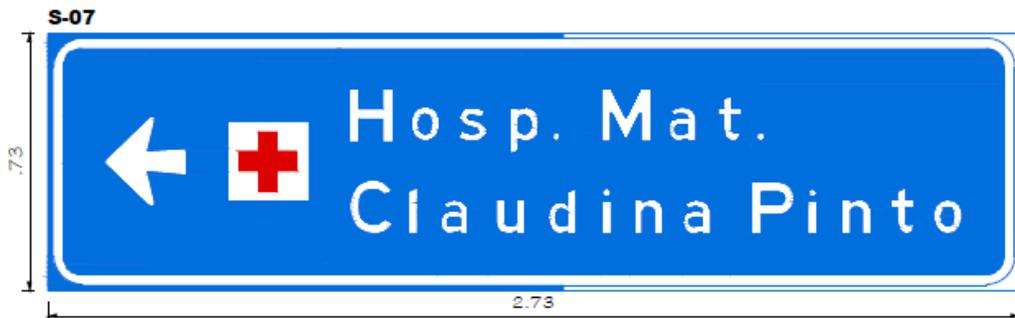
FIXAÇÃO: SUPORTE TIPO POSTE COM BRAÇO PROJETADO
