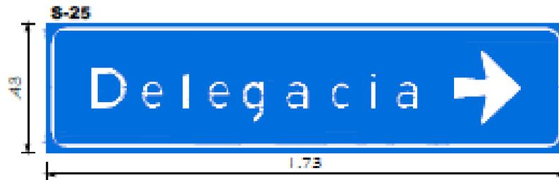
FIXAÇÃO: SUPORTE TIPO POSTE COM BRAÇO PROJETADO
